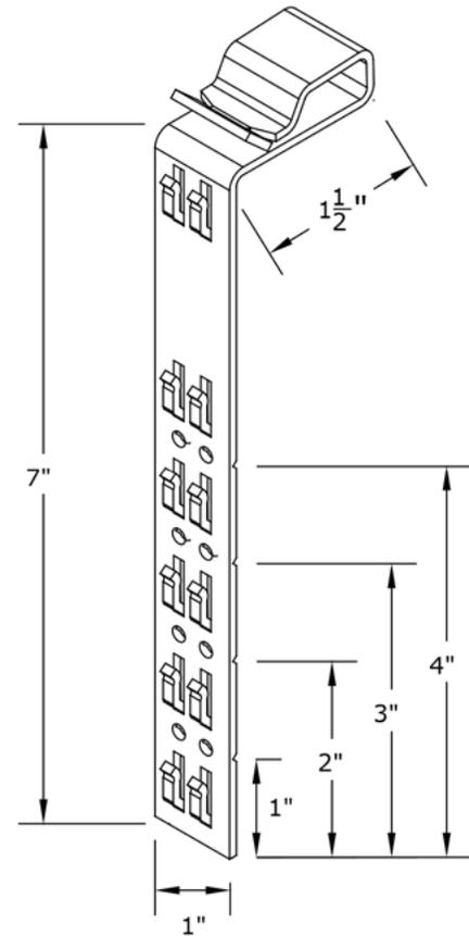
Dimensioned Array Edge Screen Clip (8" Clip Shown)
